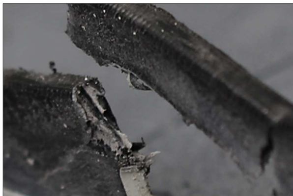
Abbildung 20: Bruchbild einer optimalen Kunststoffverschweißung
