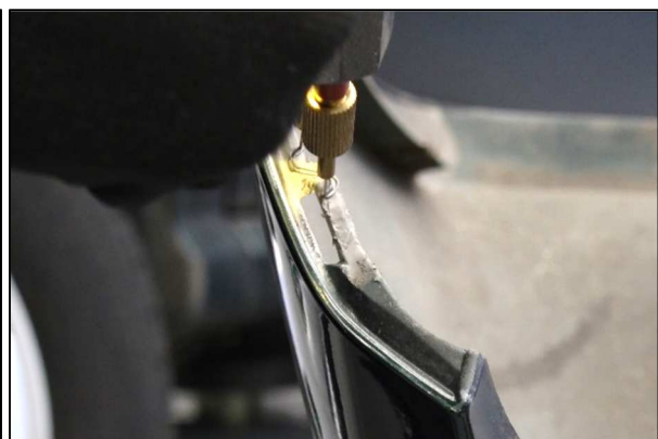
Abbildung 7: Einschweißen des Stahldrahtes
