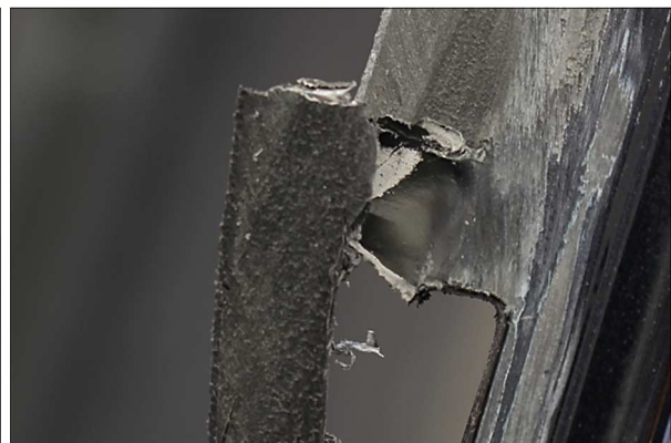
Abbildung 21: Bruchbild einer oberflächlichen Kunststoffverschweißung
