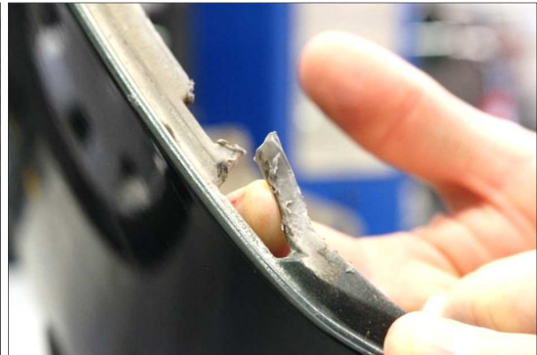
Abbildung 5: Bruch einer Befestigungslasche am Frontstoßfänger
