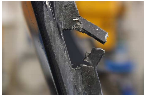
Abbildung 19: Bruch des instandgesetzten Kunststoffstegs mit Klammer
