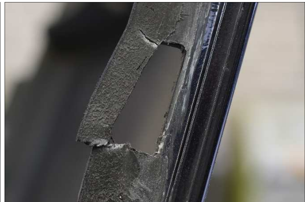
Abbildung 17: Bruch des instandgesetzten Kunststoffstegs ohne Klammer
