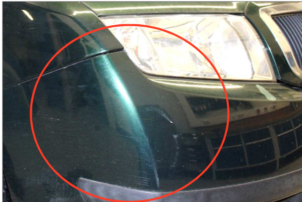
Abbildung 4: Unfallbeschädigter Stoßfänger Skoda Fabia I
