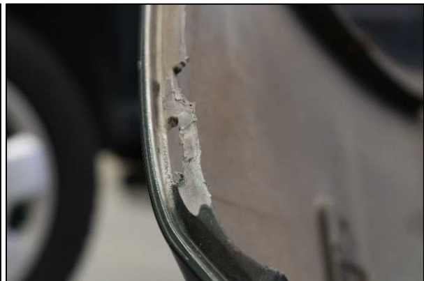
Abbildung 9: Bruchstelle nach dem Schleifen und Reinigen
