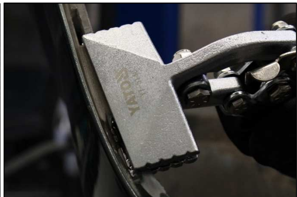
Abbildung 13: Verpressen mit Spezial-Zange
