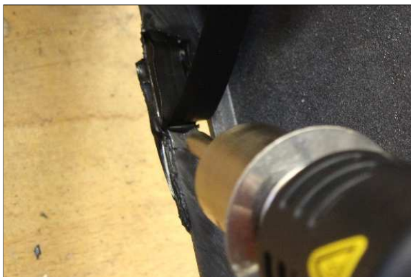
Abbildung 12: Kunststoffauftrag mit der Heißluft-Düse
