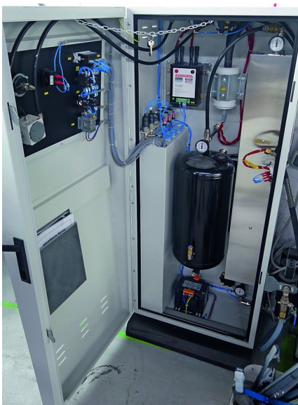
Das Innenleben des Nitro Masters: Die Gewinnung des Stickstoffs erfolgt über drei Filterstufen in der silbrigen Box rechts. Links daneben befindet sich der Stickstoff-Vorratstank.
