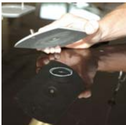
Eine Schablone kreist die ausziehende Fläche ein.
