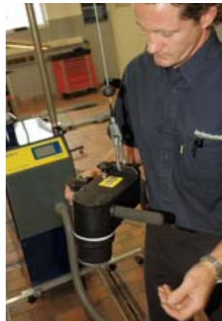
Bei voller Ladung kann der magnetische Impuls ausgelöst werden.
