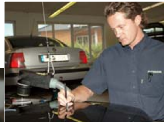
Erst wird die ausziehende Delle markiert.
