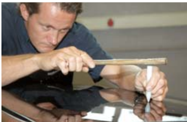
Eine Schablone kreist die ausziehende Fläche ein.
